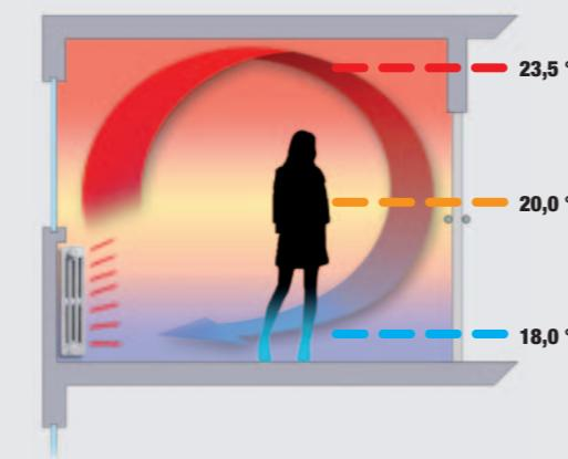
Тепло в традиционных системах отопления ( $\Delta t 50K$ ) передается конвекцией и минимальным излучением.
