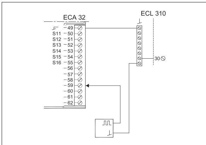
**Подключение датчиков давления с выходным сигналом 0-10 В (для приложения A376.9)**
