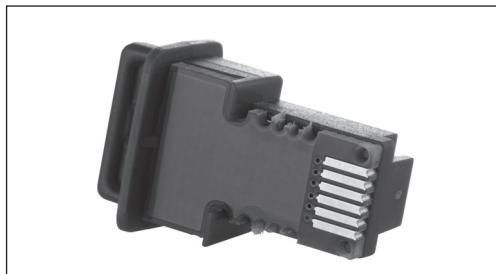
Электронный ключ программирования приложения A376 – устройство, предназначенное для обеспечения работы универсального регулятора температуры ECL Comfort 310 по управлению двумя системами отопления и одной системой ГВС.
