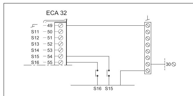
**Подключение расходомеров с импульсным сигналом
