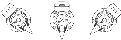
Рис. 5 Расположение клеммной коробки у одинарных насосов
