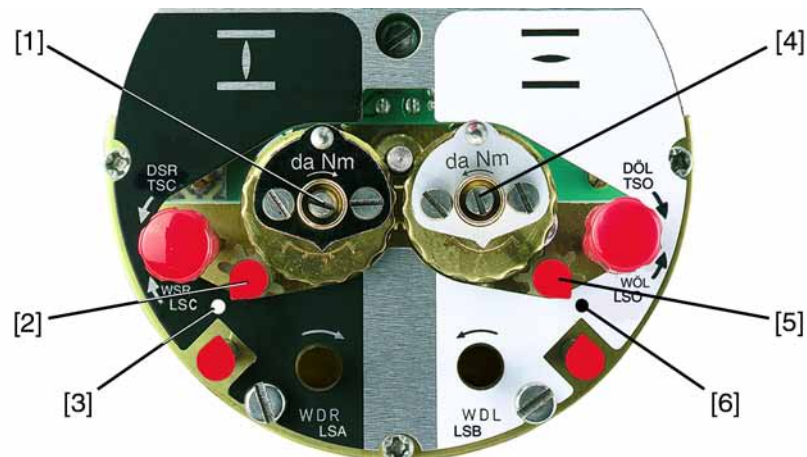
рис. 23: Регулировочные элементы концевого выключателя
